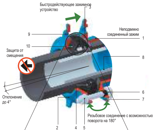
Деталь с неподвижно соединенным зажимом
